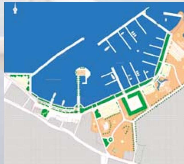
Μελέτη κατασκευής τουριστικής μαρίνας στο Χαϊκούτσι.
